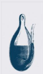
Das Donnerglas - vereinigt die Eigenschaften eines Barometers mit denen eines Thermometers. Es besitzt zumeist keine Skala, so dass die Bezeichnung „Wetterglas wohl eher angebracht ist.
