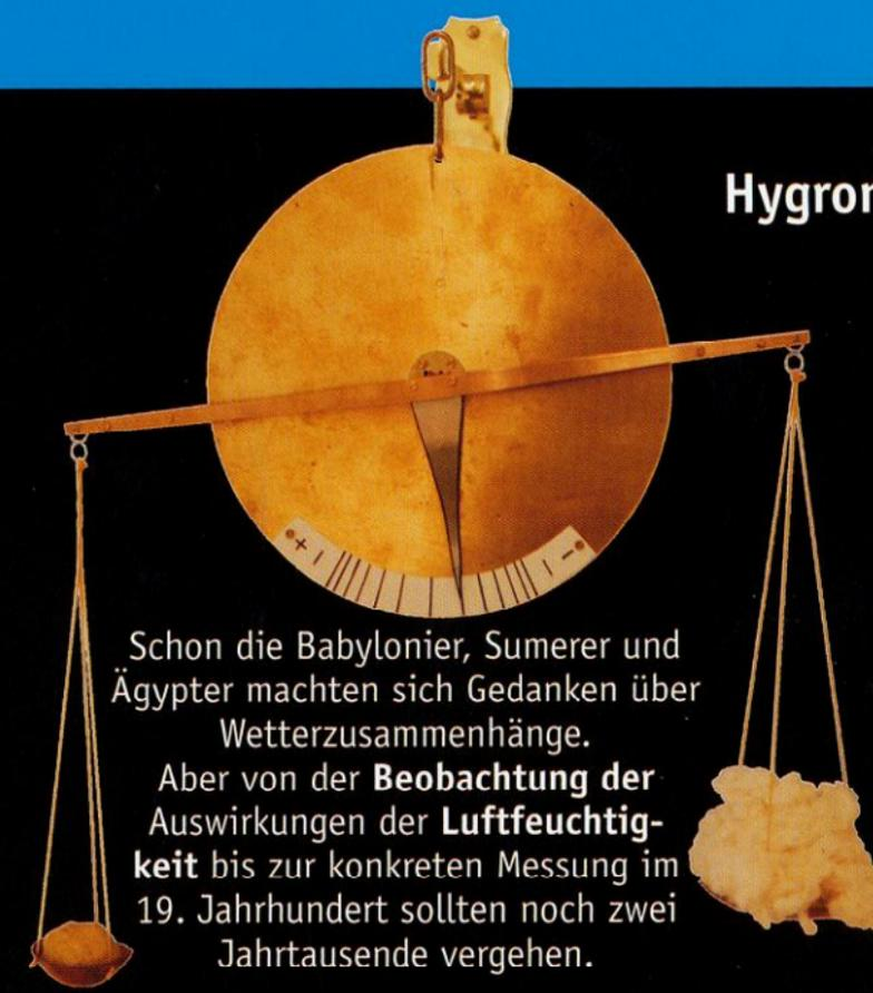
Hygroskopwaage/Hygrometer gebaut nach einer Zeichnung von Leonardo da Vinci
