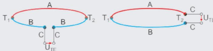
Die Thermospannung  $U_{TE}$  ist von der Materialkombination A/B und den Temperaturen  $T_1$  und  $T_2$  der Verbindungsstellen abhängig. Für den Fall  $T_1 = T_2$  gilt für alle Materialkombinationen  $U_{TE} = 0$ .
